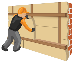
Рис. 7.5. Монтаж теплоизоляционных плит в горизонтальный каркас
