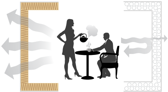
Рис. 1.3. Сравнение утепленного каменной ватой и пенопластом помещений.
