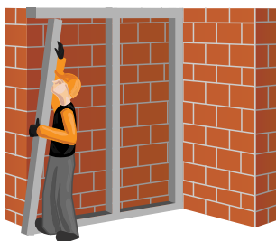
Рис. 6.9. Установка стоечного профиля
